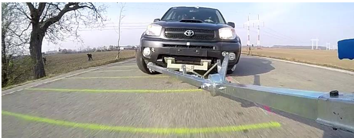
Obrázek 53 Moment odepinání synchronizačního zařízení na vypínací desce
