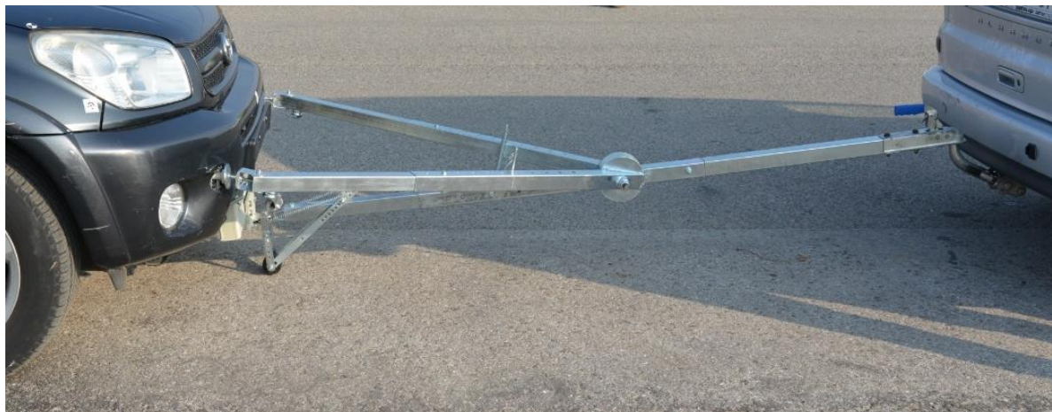
Obrázek 48: Spojení vozidel Toyota RAV4 a Seat Alhambra roztahovacím mechanismem
