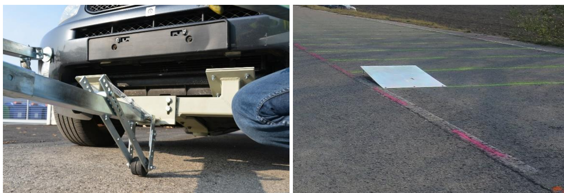
Obrázek 49: Detail spojovacího zařízení a vypínací deska umístěná na komunikaci
