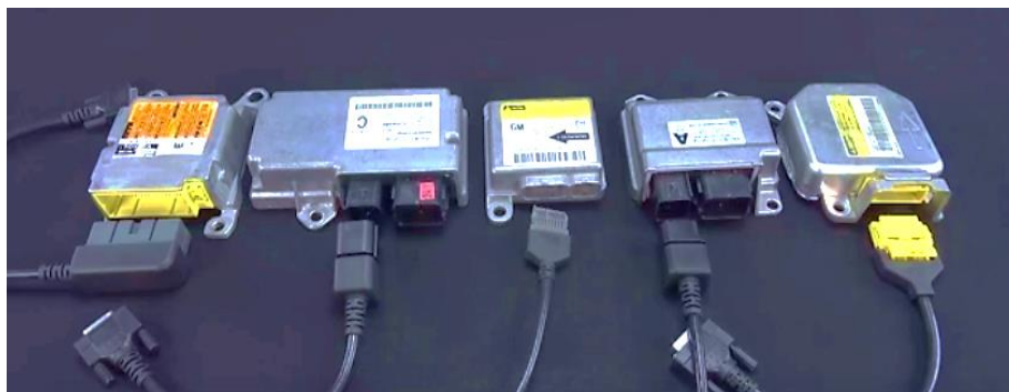
Obrázek 24: Různá provedení ACM a kompatibilní konektory [85]
