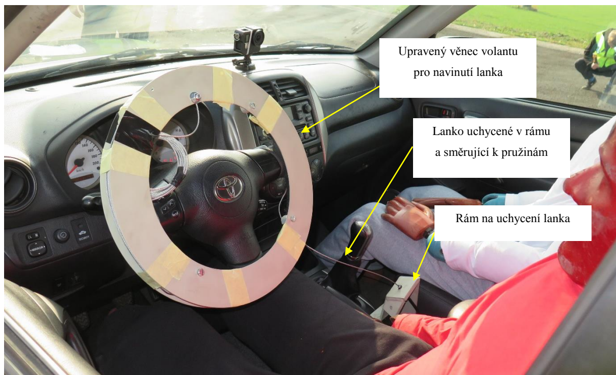
Obrázek 51: Plechový věnec připevněný k volantu a mechanismus fixace bovdeny a ocelového lanka
