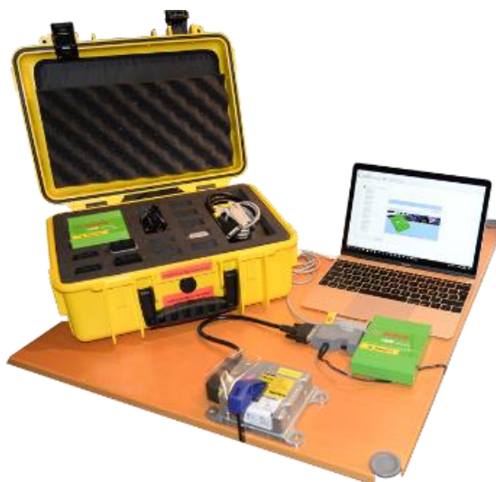
Obrázek 23: D2M připojení, modul vyjmut z vozidla (zdroj: https://www.kneifel.de )
