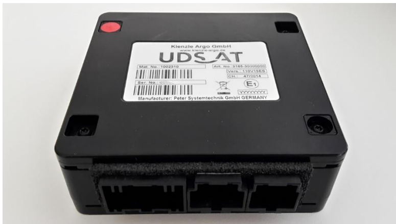
Obrázek 17: UDS-AT se třemi rozhraními, vlevo 16-pinový (připojení vozidla), uprostřed 10-pinový (GPS), vpravo 8-pinový (USB 2.0), (zdroj: https://www.colliseum.net/wiki/UDS-AT )
